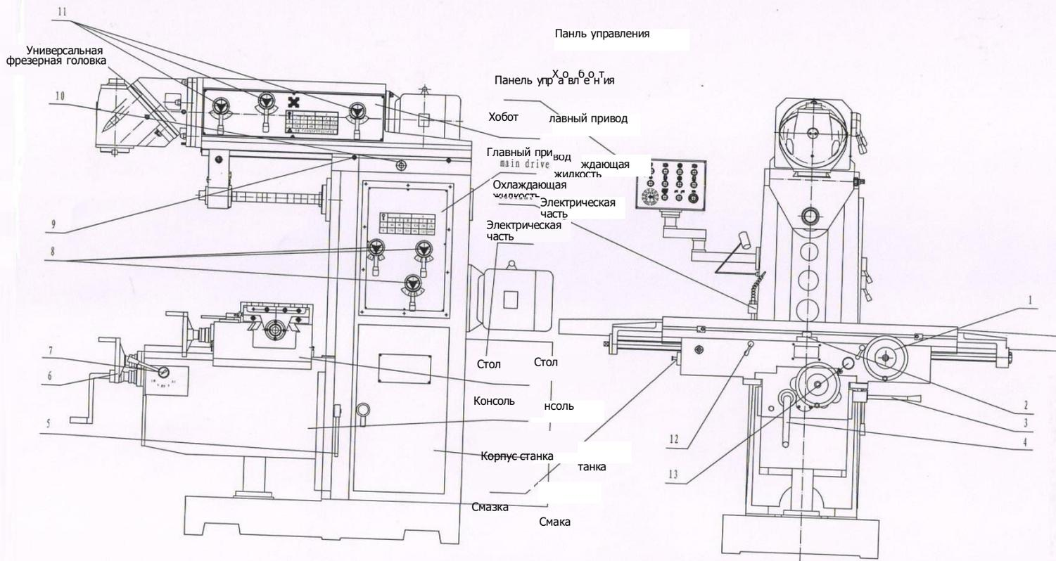
Рисунок 1-2. Внешний вид конструкции
