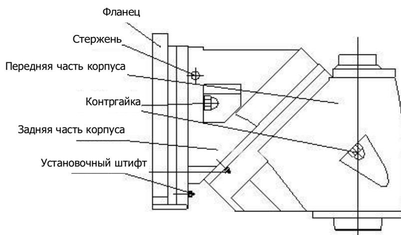
b). Смещение шпинделя универсальной фрезерной головки влево и вправо
